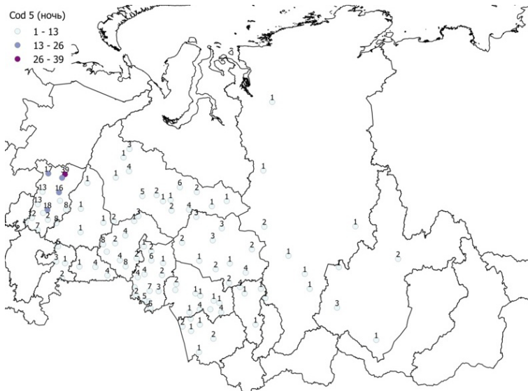
Рис. 5. Распределение частот типов гололеда по метеостанциям за период 2014–2017 гг.: код 5 – ночное время
